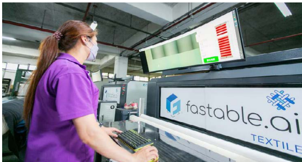
圖四十七 台灣富綢運用 AI 圖像學習打造自動驗布系統，自動辨識瑕疵
