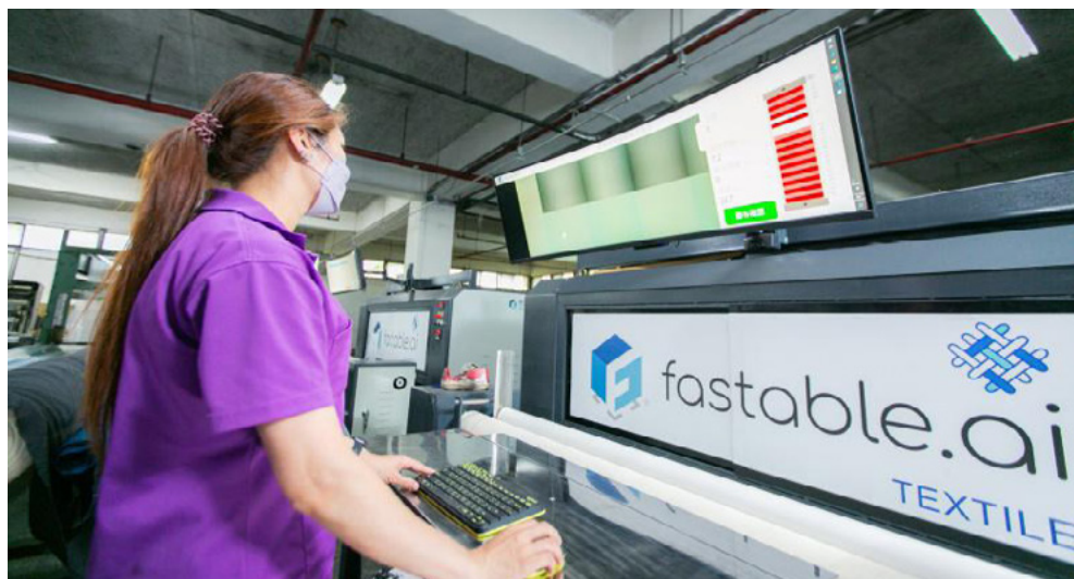
圖三十六 台灣富綢運用 AI 圖像學習打造自動驗布系統，自動辨識瑕疵
