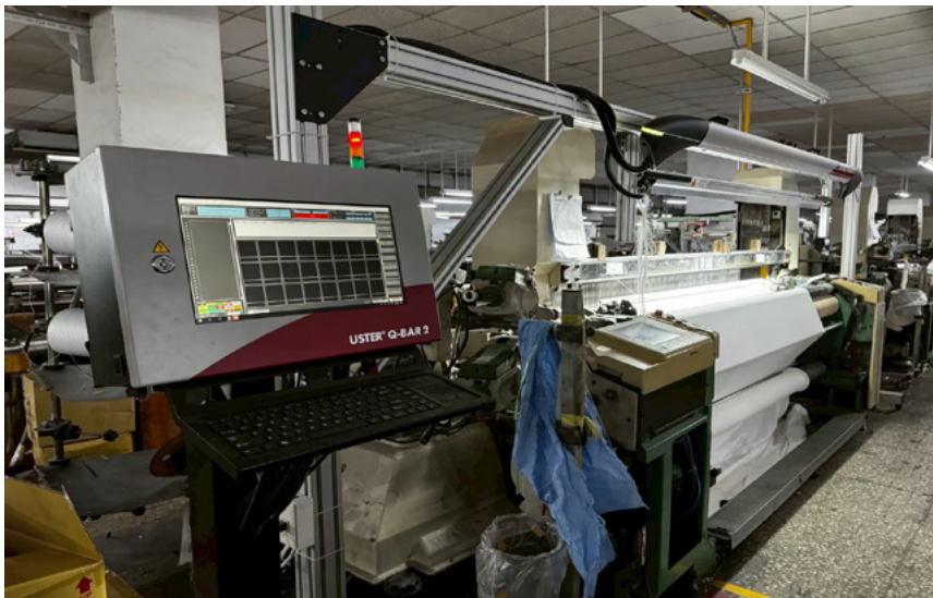
圖四十四 機上 AI 驗布系統，以數據分析系統提升織布良率與品質
